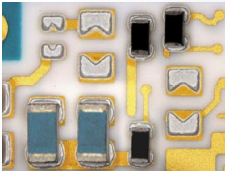
导电胶印刷在电路板上
